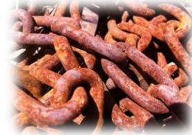
Otro ejemplo de oxidación, donde el hierro reacciona con el oxígeno para formar óxido de hierro, también llamado óxido de hierro III ( $2 \text{Fe}_2\text{O}_3$ ).
