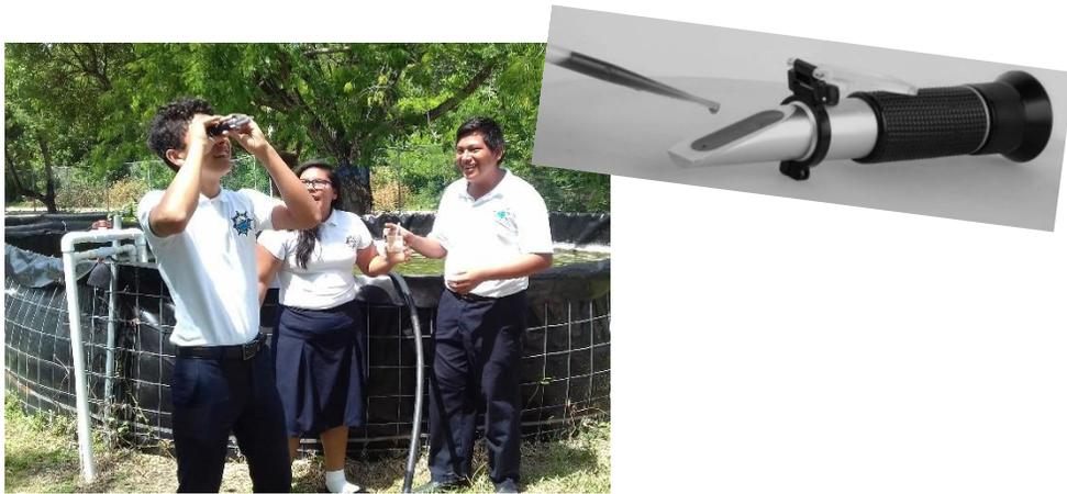
*Uso del refractómetro para medición de salinidad. Fotografía: Canul Ramírez, 2021.*
