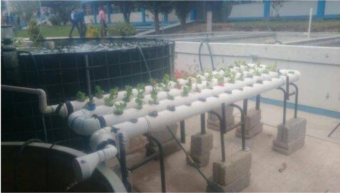
*Sistema acuapónico compuesto por sistemas de filtración mecánica, biológica donde se mantiene en cultivo tilapia y lechugas.*
