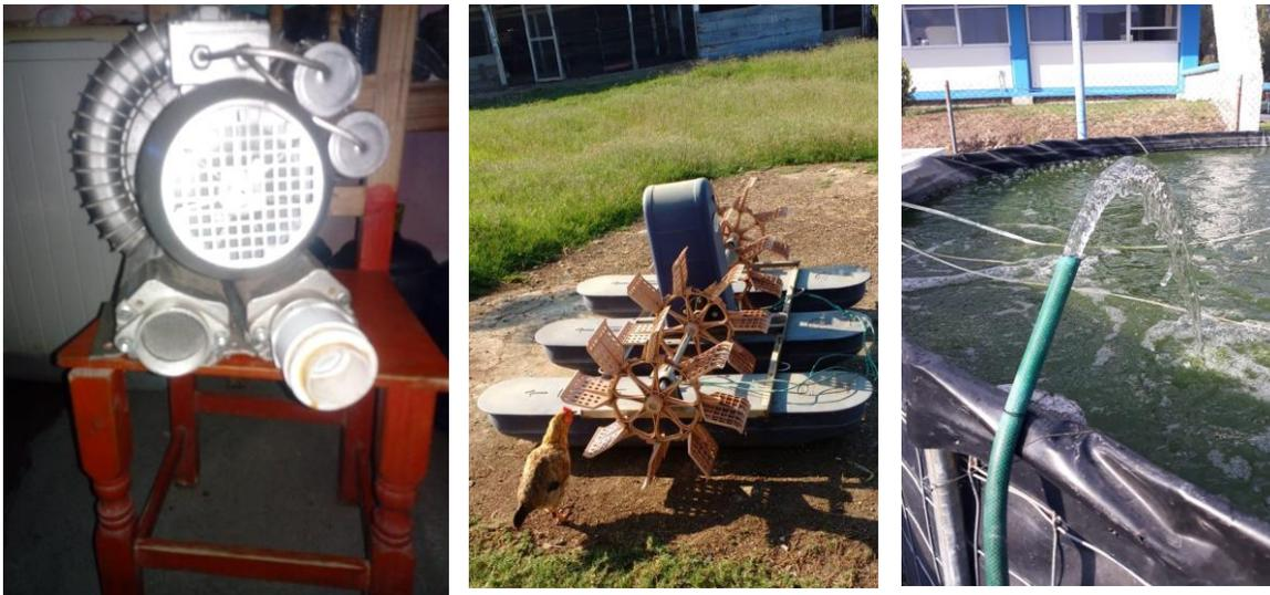
*Sistemas para el suministro de oxígeno en sistemas de estanquería rústicos, concreto y geomembrana.*
