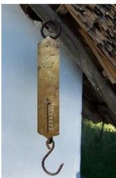
**El peso:** es la fuerza de atracción con la que los cuerpos te atraen hacia su centro por efecto de la gravedad, su unidad de medida es el Newton (N) y su instrumento de medición es el dinamómetro.
